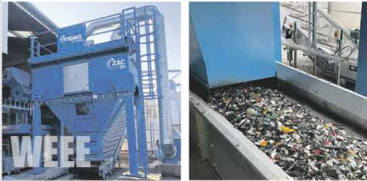
Zigzag Air Classifier (ZAC) System
